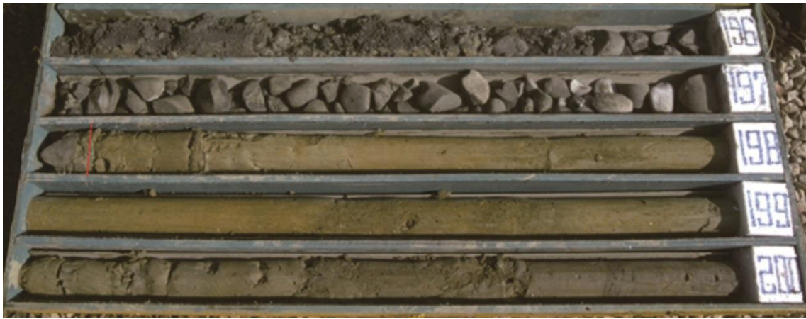
圖 5.1 PC-2 岩芯，195~200 公尺段。第三紀基盤面位於 197.1 公尺左右(紅線位置)；基盤面上沉積物為礫石層夾砂層，底下以黃棕色泥質細砂岩(似為風化岩層)為主。
