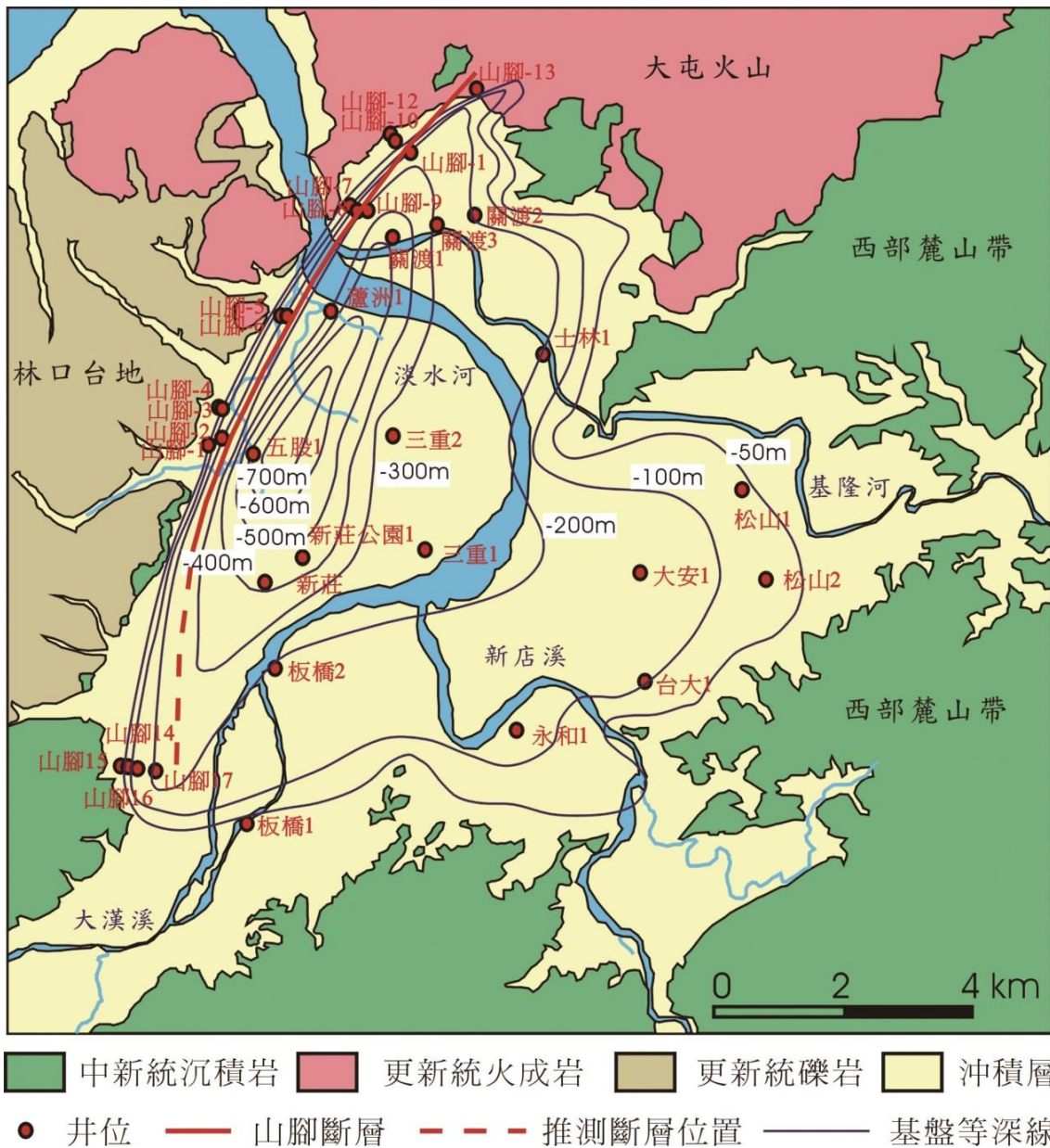
圖 6.4 陳文山等人(2008)在其研究中使用了 34 口鑽井資料，繪製基盤等深圖。由圖中可以看到在山子腳背斜附近加入了四口鑽井資料，也使山腳斷層跡從新莊延伸至樹林地區。他們也認為盆地西緣(五股、關渡)的基盤等深線應僅有單一圈合。
