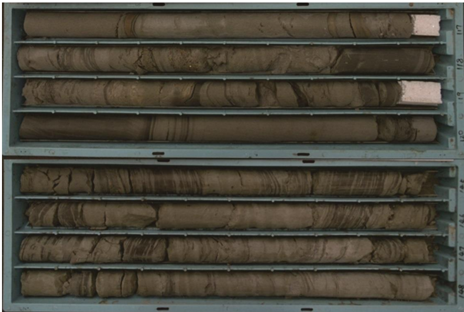
圖 5.26 SS-2 岩芯，116~120 公尺段以泥岩或頁岩間夾白砂岩為主、144~148 公尺段以灰色砂頁岩薄互層為主，基盤經判釋為南莊層。
