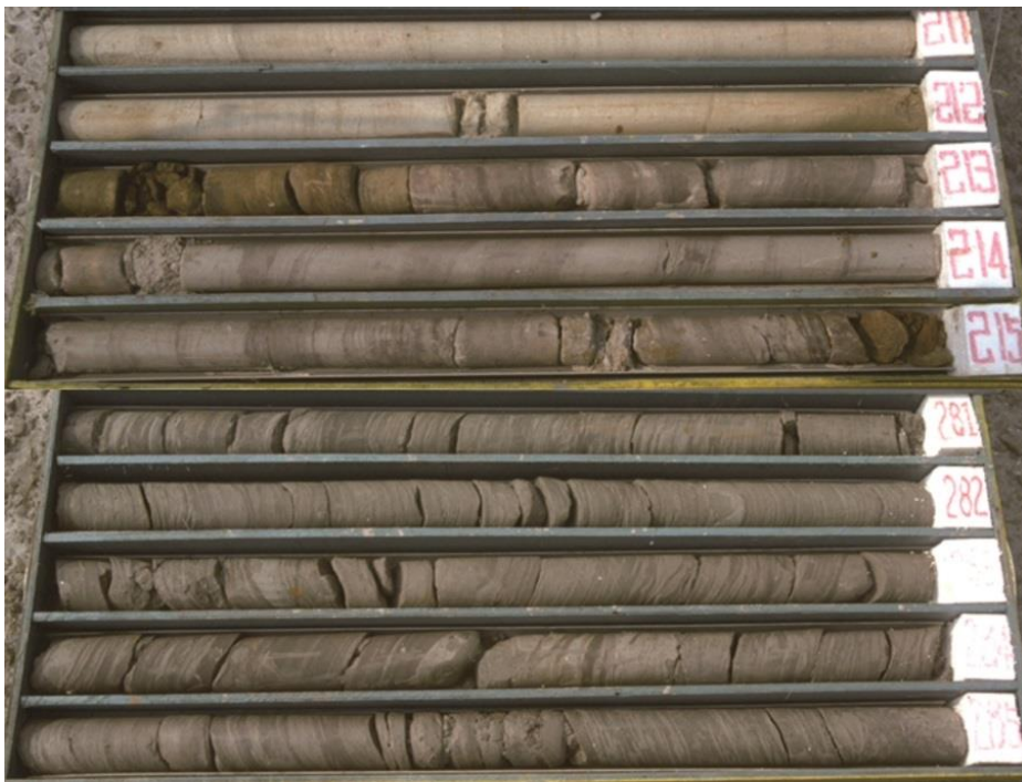
圖 5.24 PC-2 岩芯，210~215 公尺段以白色中至粗粒砂岩夾薄泥岩層與碳層為主、280~285 公尺段以深灰色砂頁岩薄葉互層為主，基盤經判釋為南莊層。
