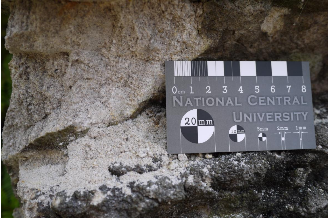
圖 3.14 五指山層之厚層白色中至粗粒砂岩，砂岩中石英含量高。
