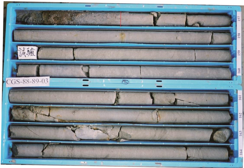
圖 5.13 TA-1 岩芯，156~164 公尺段。第三紀基盤面位於 156.5 公尺左右； 基盤岩層以青灰色粉砂岩為主。
