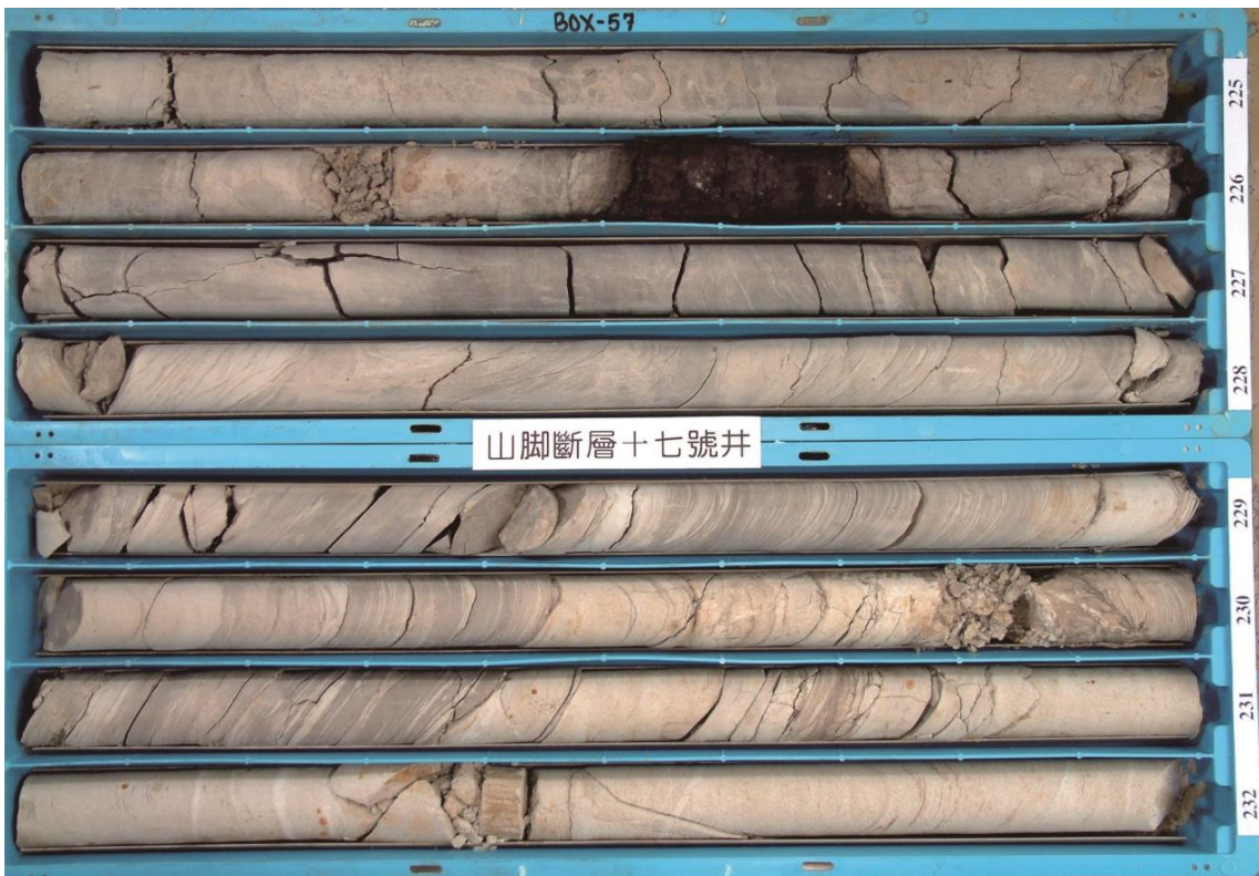
圖 3.9 SCF-17 岩芯，224 公尺~232 公尺段，本段為石底層。
