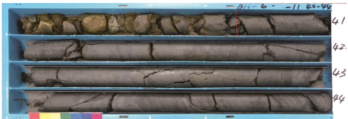
圖 5.22 SHL-1 岩芯，40~44 公尺段。第三紀基盤面位於 40.7 公尺左右；基盤岩層以灰色頁岩夾薄砂層為主，其上為礫石層夾黃棕色砂。
