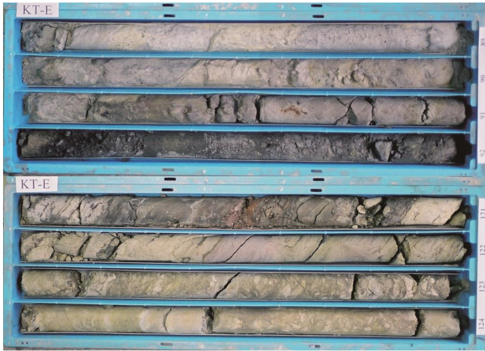
圖 5.36 SCF-10 岩芯，上段 88~92 公尺以灰白色粗粒疏鬆砂岩為主，為五指山層；通過剪切帶後為下段，下段 120~124 公尺以淡灰色細至中粒砂岩、灰色細粒泥質砂岩，受高度生物擾動為主，可能為南莊層。
