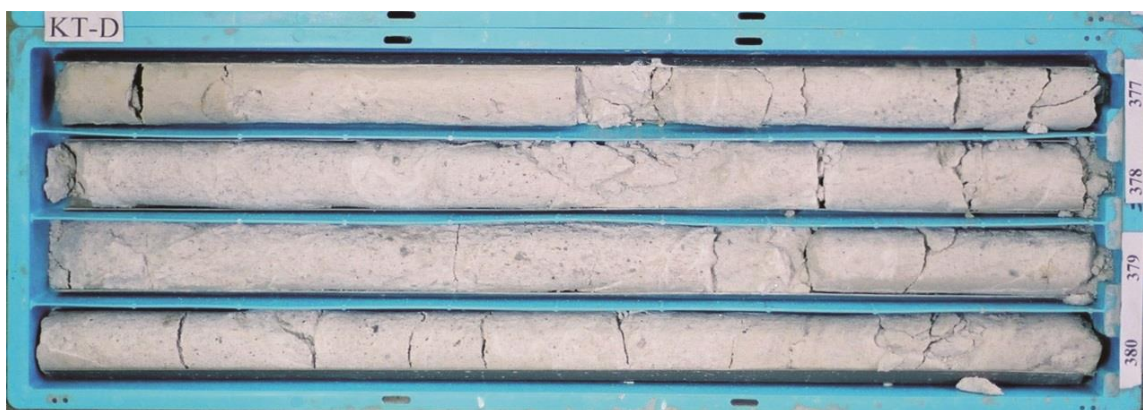
圖 5.49 SCF-09 岩芯，376~380 公尺段以灰白色中粒疏鬆砂岩為主，判斷可能為木山層。
