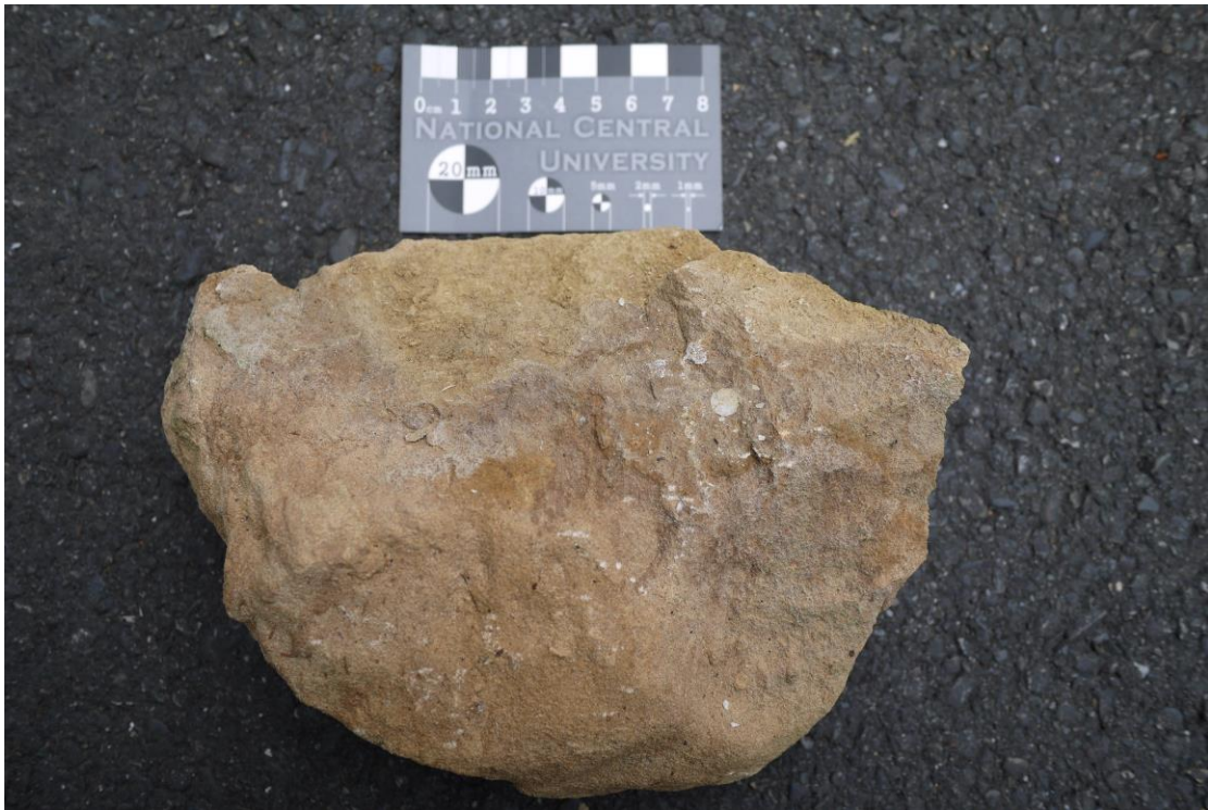
圖 3.18 本露頭所採之塊狀棕黃色細粒砂岩，含有化石或鈣質沉積物，滴稀鹽酸會產生冒泡反應；經判斷後，本露頭應屬大寮層。
