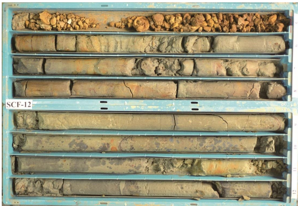
圖 5.10 SCF-12 岩芯，4~12 公尺段。第三紀基盤面位於 5 公尺左右；本井的基盤面非常淺，基盤岩層以淡灰色粉砂岩至極細粒泥質砂岩為主。
