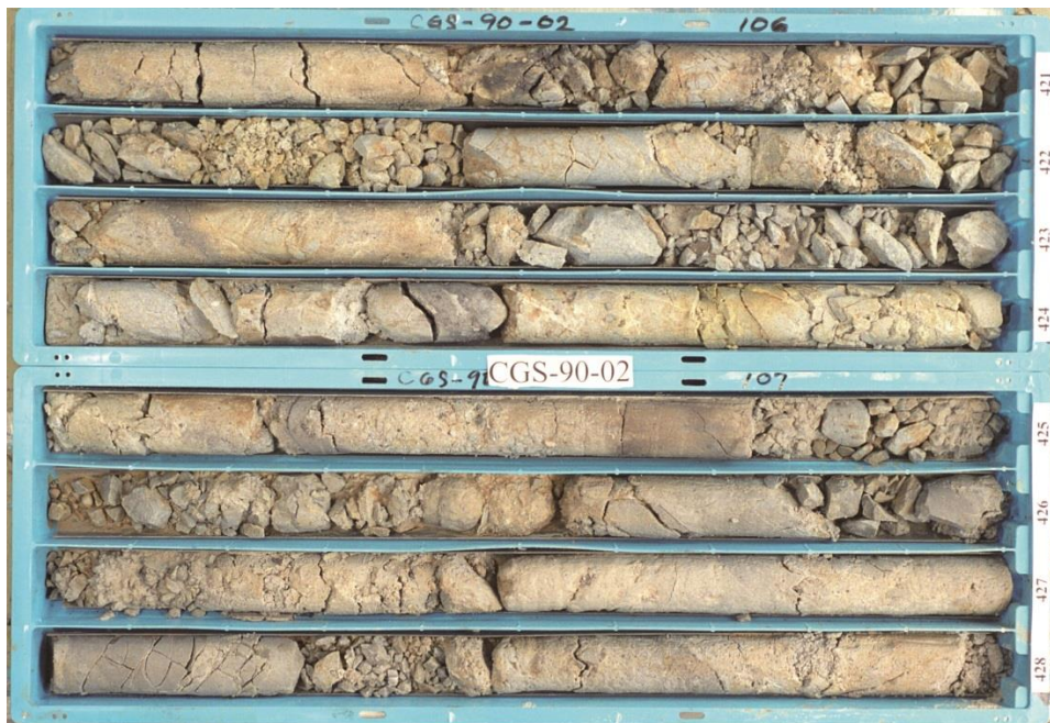
圖 5.37 SCF-13 岩芯，420~428 公尺段以灰白色中至粗粒石英砂岩為主，膠結差且部分破碎；可能為五指山層。
