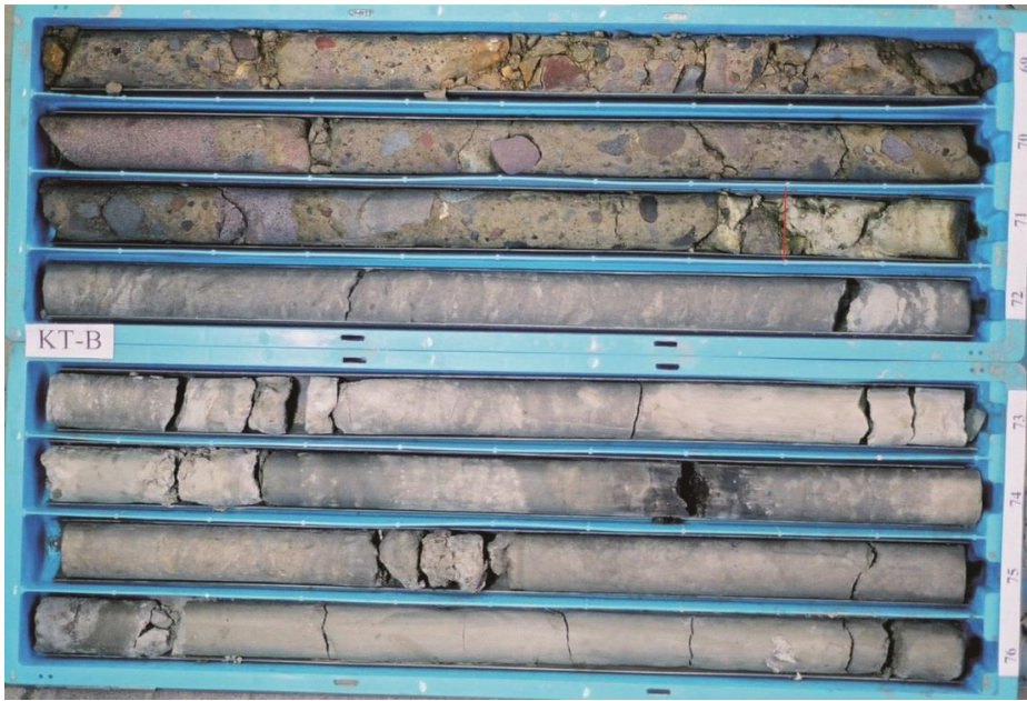
圖 5.23 SCF-07 岩芯，68~76 公尺段。第三紀基盤面位於 70.8 公尺左右；基盤岩層以灰白色疏鬆砂岩為主，其上為火山碎屑沉積物。
