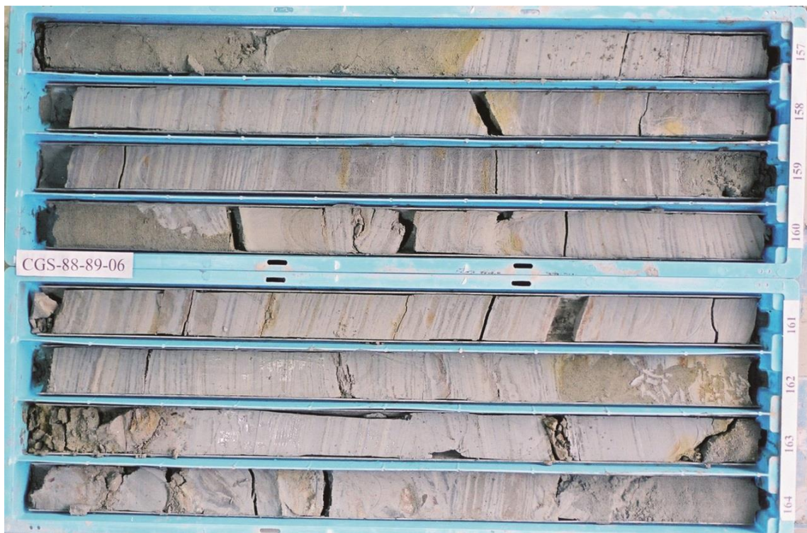
圖 3.5 SCF-02 岩芯，156 公尺~164 公尺段，本段為板橋層。
