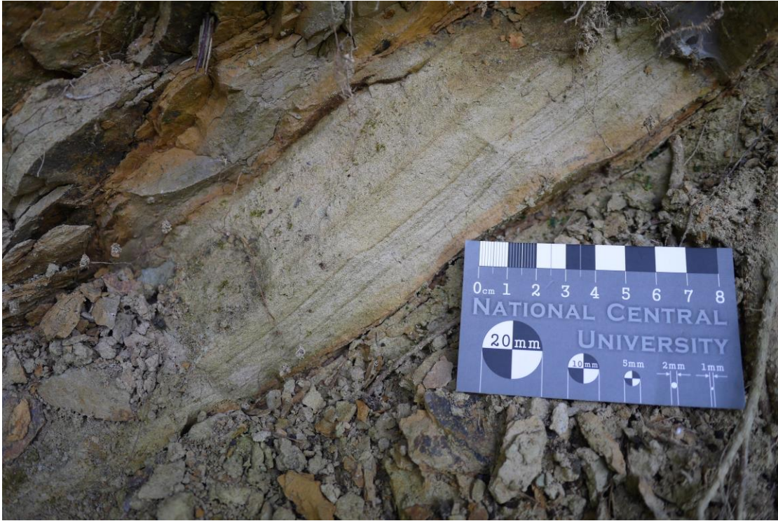
圖 3.20 本露頭以中層灰白色細粒砂岩為主，經判斷後應屬石底層。此露頭走向為北偏東 85 度，向北傾 35 度。
