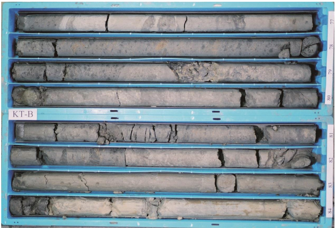
圖 5.47 SCF-07 岩芯，76~84 公尺段以灰白色疏鬆砂岩為主，剪裂帶夾灰色泥岩，判斷可能為南莊層。
