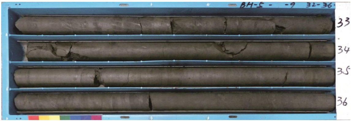
圖 5.46 CH-1 岩芯，32~36 公尺段以灰色砂岩，偶夾薄層頁岩為主，判斷可能為桂竹林層。
