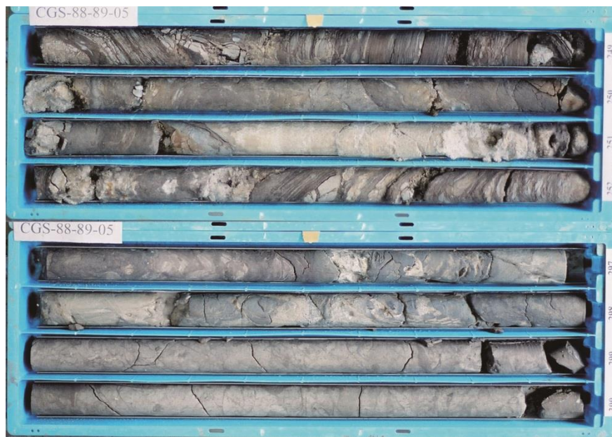
圖 5.31 SCF-06 岩芯，上段 248~252 公尺以灰白色中粒砂岩、粉砂岩與頁岩之薄頁互層為主，為南莊層；下段 296~300 公尺以白色中至粗粒砂岩夾泥岩為主，岩層受高度生物擾動，可能為桂竹林層。
