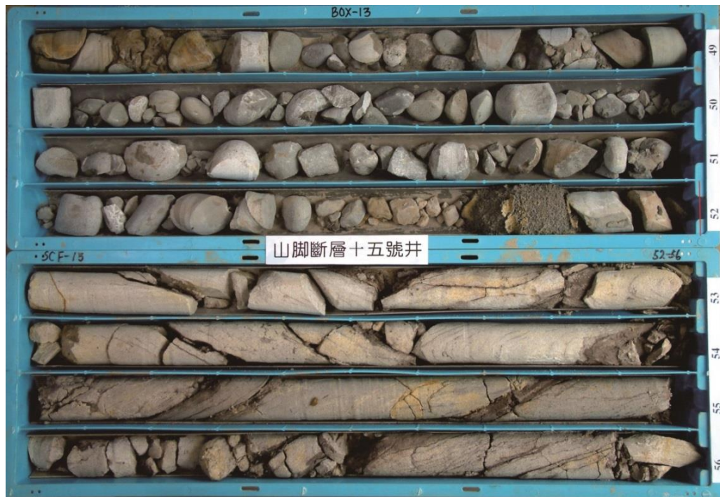
圖 5.17 SCF-15 岩芯，48~56 公尺段。第三紀基盤面位於 52 公尺左右；基盤岩層以白色石英砂岩夾薄碳層為主，其上為礫石沉積物。
