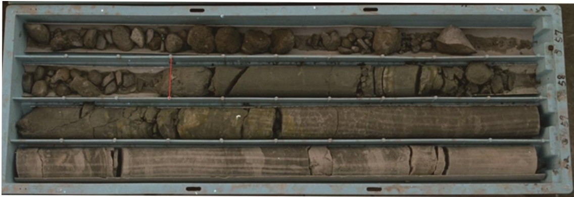
圖 5.3 SS-1 岩芯，56~60 公尺段。第三紀基盤面位於 57.3 公尺左右(紅線位置)；基盤岩層以青灰色粉砂岩、灰色細粒砂岩偶夾薄層頁岩為主，其上為礫石層沉積物。
