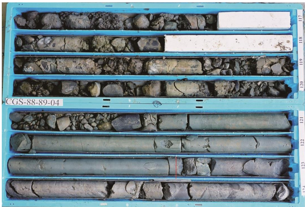
圖 5.8 SCF-05 岩芯，116~124 公尺段。第三紀基盤面位於 122.6 公尺左右；基盤岩層受到強烈剪動。
