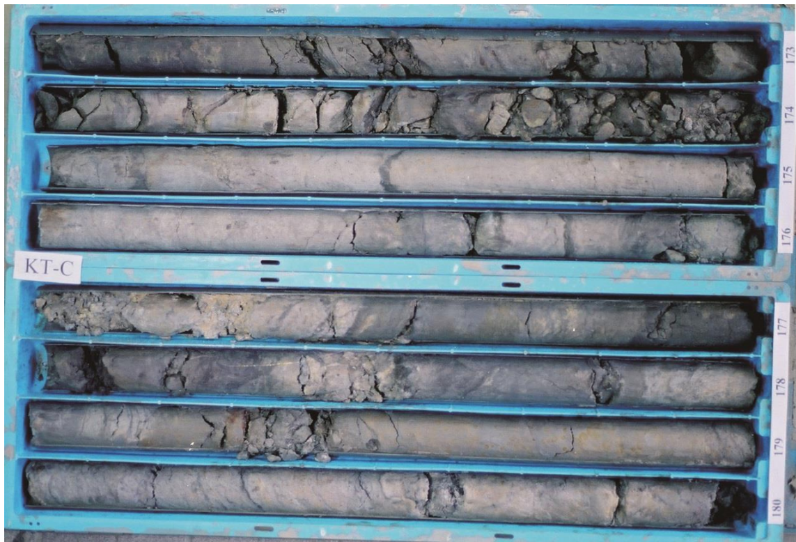
圖 5.48 SCF-08 岩芯，172~180 公尺段以砂岩夾頁岩為主，且頁岩為剪裂帶；同 SCF-07，判斷可能為南莊層。
