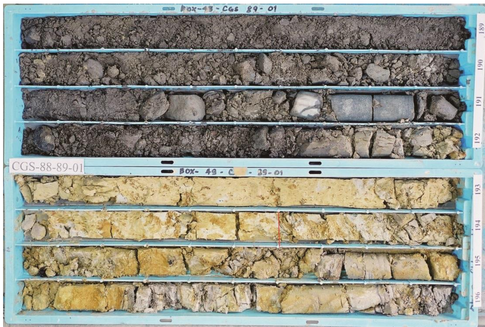
圖 5.5 KT-2 岩芯，188~196 公尺段。第三紀基盤面位於 193.6 公尺左右；基盤岩層以風化、灰白色中粒砂岩夾泥岩之薄葉互層為主。
