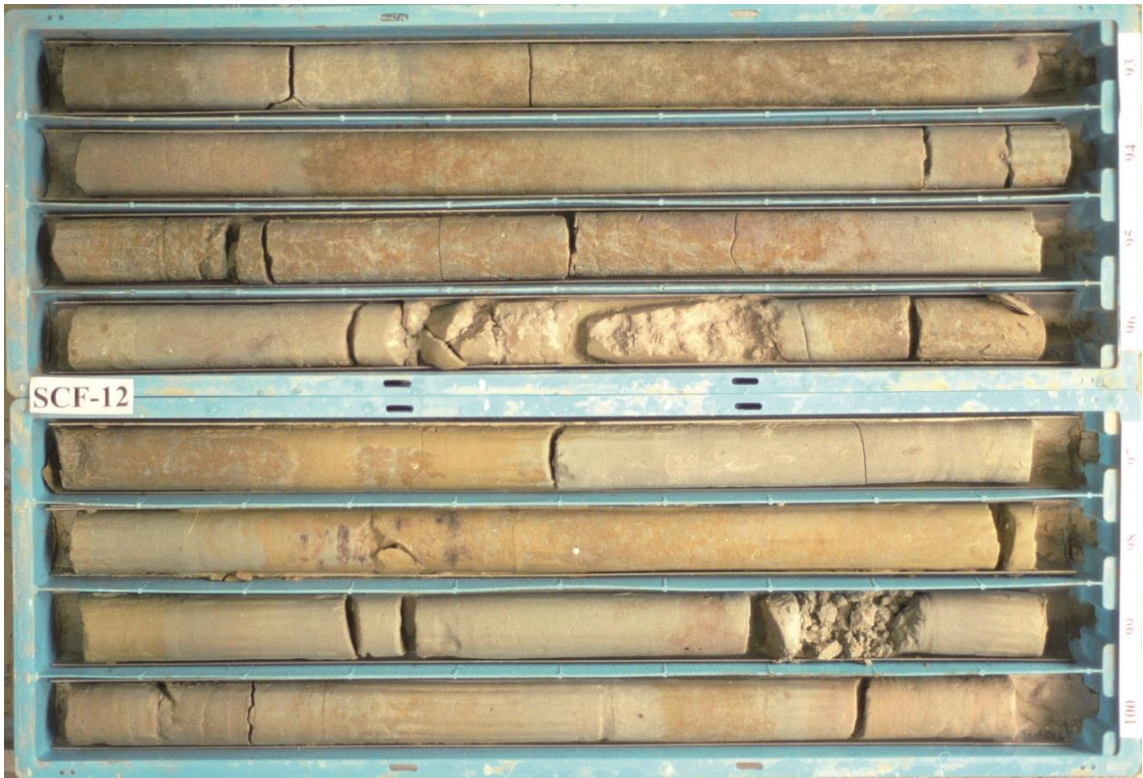
圖 5.32 SCF-12 岩芯，92~100 公尺段以灰色粉砂岩、淡灰色極細粒砂岩夾薄層泥質砂岩為主，基盤經判釋為南莊層。
