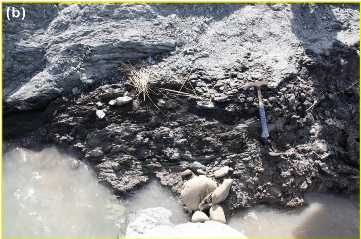
圖 37  $F_1$  斷層帶中斷層泥與青灰色砂岩
