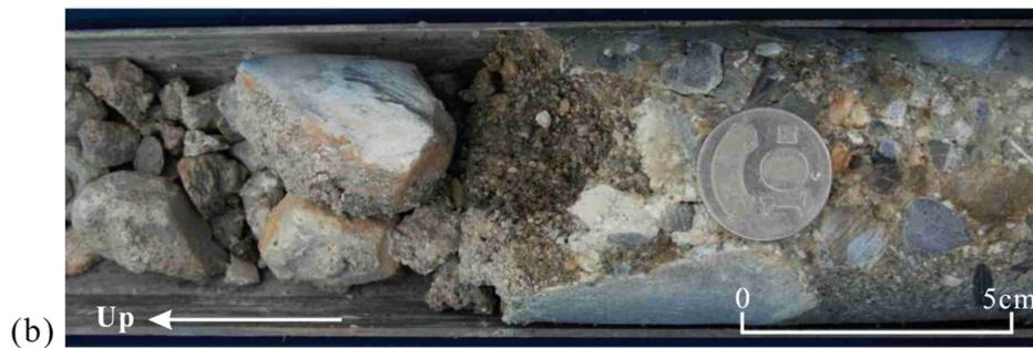
圖 81 岩心分層-淘選度差之礫石層。(a)BH-03 中 24-28 米深的岩心照片，礫石大小差異極大，基質為粗砂質(b)BH-01 中 27.5-27.7 米深的近照，能清楚看到礫石層中的基質。
