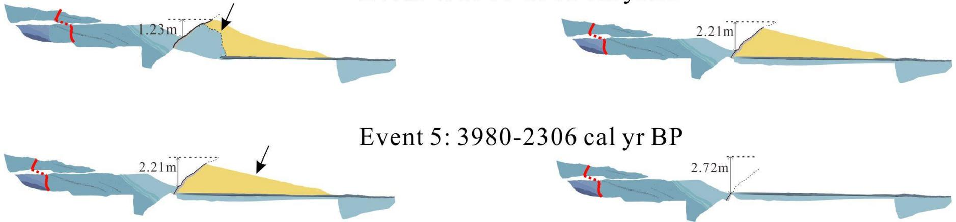
圖 88 1 號槽溝西牆剖面之構造回復圖(事件四~事件五)。左側皆為地震發生後之剖面，右側為地震前之剖面，黑色箭頭為每次事件的判斷依據，數字為剖面回覆時可能的累積垂直錯移量。
