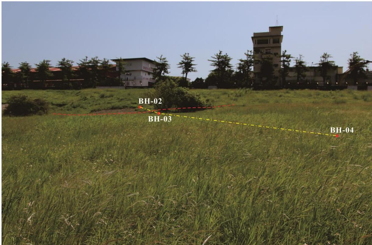
圖 43 BH-02、BH-03 與 BH-04 分布圖。照片中三口井的分布方向(黃色虛線)與 2 號槽溝長邊平行，並與地表破裂跡(紅色虛線)相互垂直。
