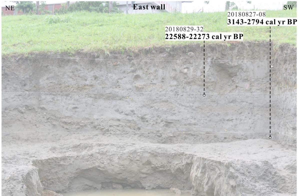
圖 77 2 號槽溝標本採樣位置與定年結果
