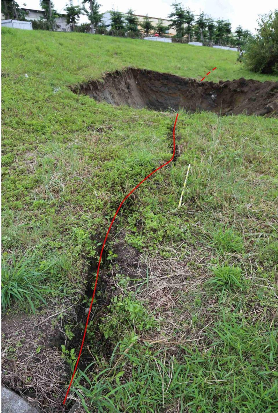
圖 68 2 號槽溝橫跨 2018 花蓮地震地表破裂跡
