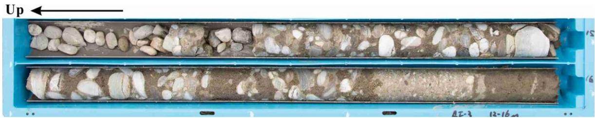
圖 80 岩心分層-中砂層夾薄礫石層。此為 BH-03 中 14-16 米深的岩心照片，為基質支持的礫石層，基質為中砂，礫石皆為橢圓狀且無稜角，大小則從數毫米至 6 公分不等。
