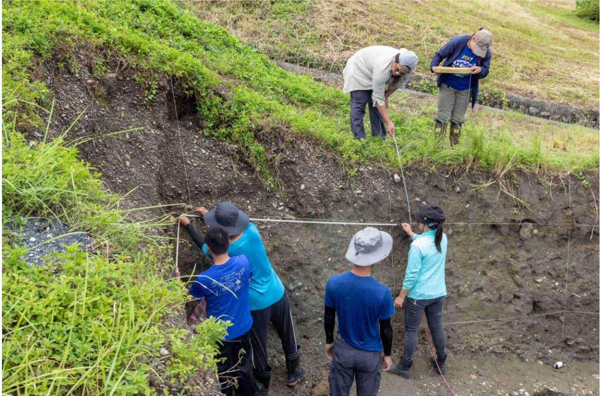
圖 41 設置水平及垂直網格線
