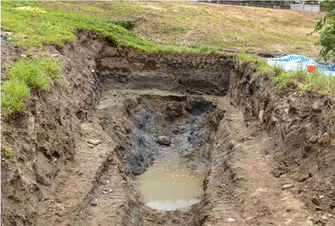
圖 45 1a 槽溝南牆照片。照片中可見兩顆崩落的巨礫，且水不斷滲至槽溝內。
