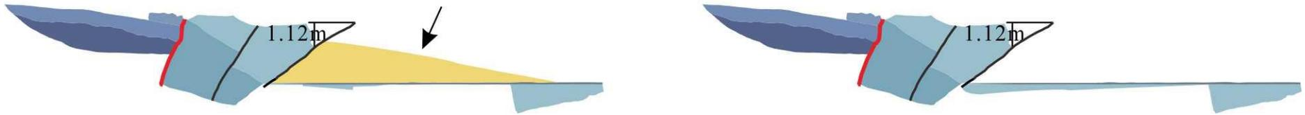
圖 89 1 號槽溝東牆剖面之構造回復圖。左側皆為地震發生後之剖面，右側為地震前之剖面，黑色箭頭為每次事件的判斷依據，數字為剖面回覆時可能的累積垂直錯移量。
