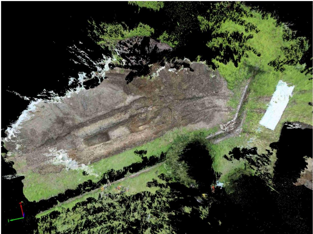
圖 42 PIX4D 軟體合成之 3D 槽溝影像
