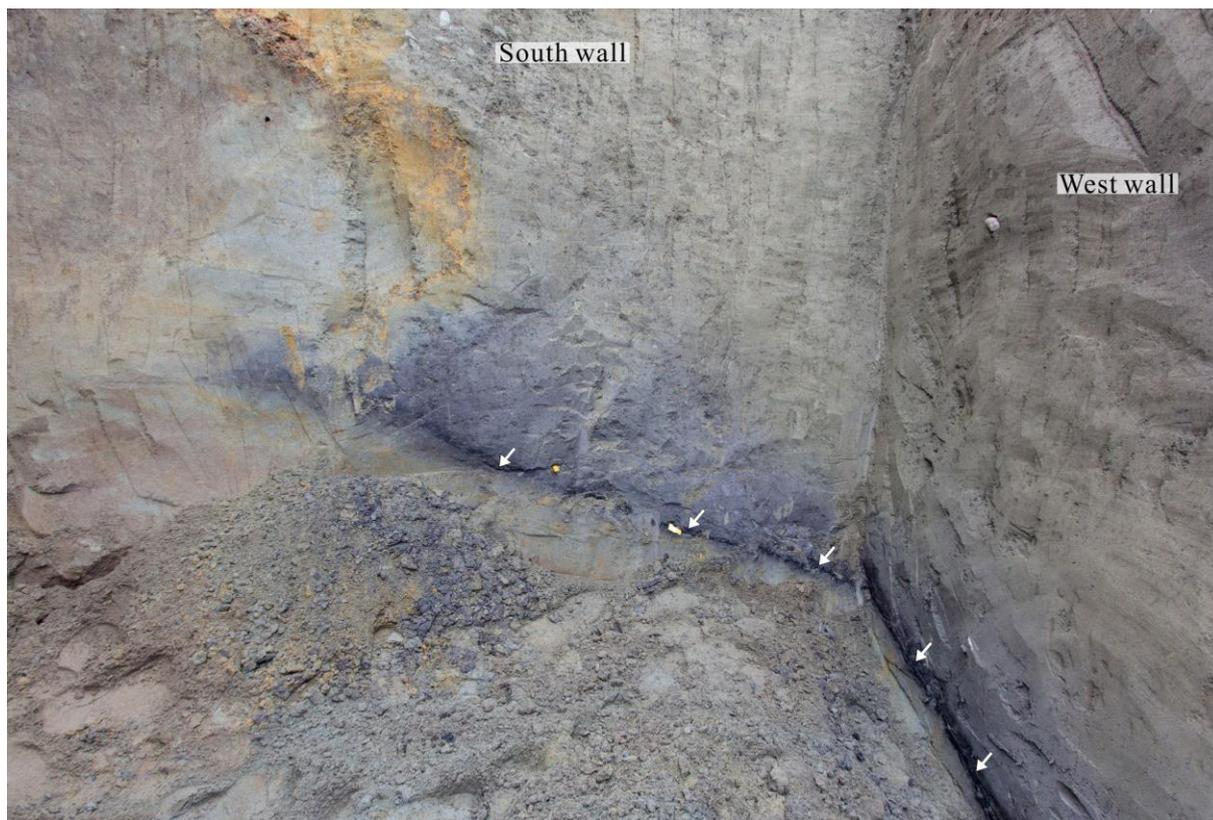
圖 52 碳質黑色泥層(Unit 5)。本照片位於 1b 槽溝南牆及西牆照片，白色箭頭所指的即為厚度約 2 公分的黑色泥質炭層，且可看到顏色向上逐漸變淺，顆粒大小也從泥質變成砂質。
