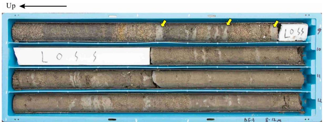
圖 78 岩心分層-中砂及粗砂層。此為 BH-03 中 8-12 米深的岩心照片，以海相的中砂層與粗砂層組成，粗砂層中富含貝殼碎屑，黃色箭頭所指為因鈣化作用並膠結而形成較為堅硬的部分。
