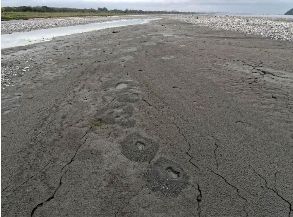
圖 18 花蓮大橋附近出現的破裂跡與噴砂孔(摘自中央地質調查所, 2018)。
