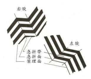
圖 1.3 右旋與左旋單斜急折褶皺之示意圖。修改自(Davis et al., 2011)。
