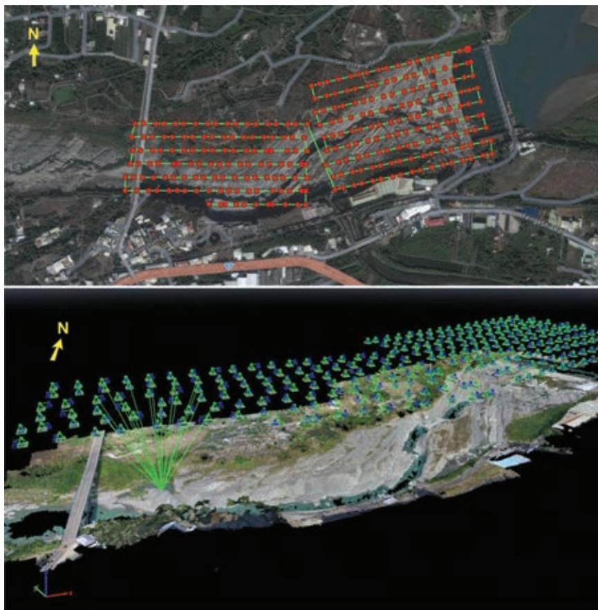
飛航軌跡及地表數值模型示意圖，上圖為無人機飛行的軌道及航照拍攝的位置（在大甲溪埤豐橋），下圖為影像處理軟體計算出的地表數值模型。
