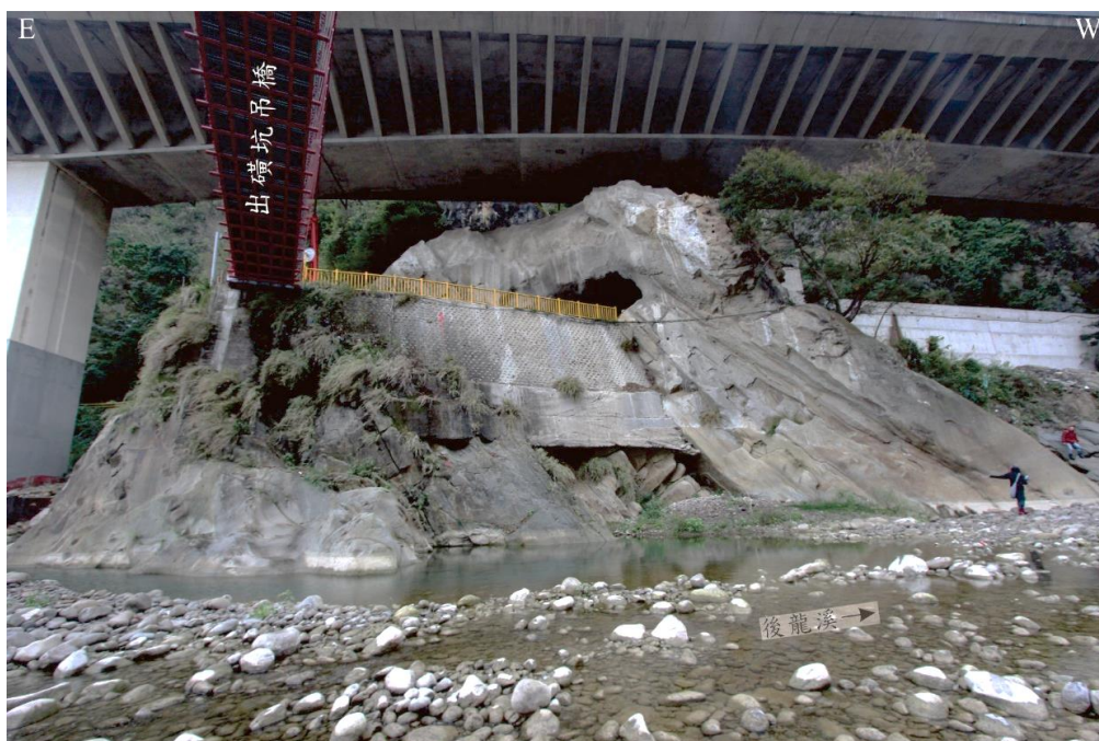
圖 32 出磺坑吊橋下方出露厚層塊狀砂岩。根據出露位置及岩性，於露頭 HL-1.2 出露(位置參照圖 31)之厚層塊狀砂岩應屬北寮砂岩之部分岩段。
