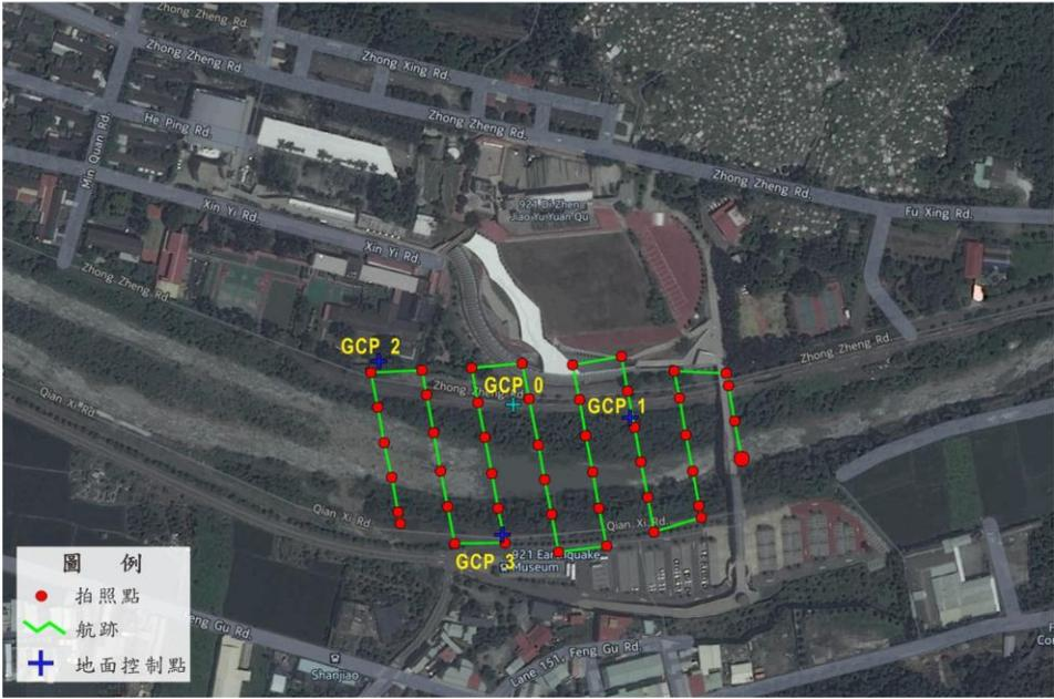
圖 41 UAV 飛航軌跡圖。本模型使用一次飛行航次，航跡有 8 個軌道。
