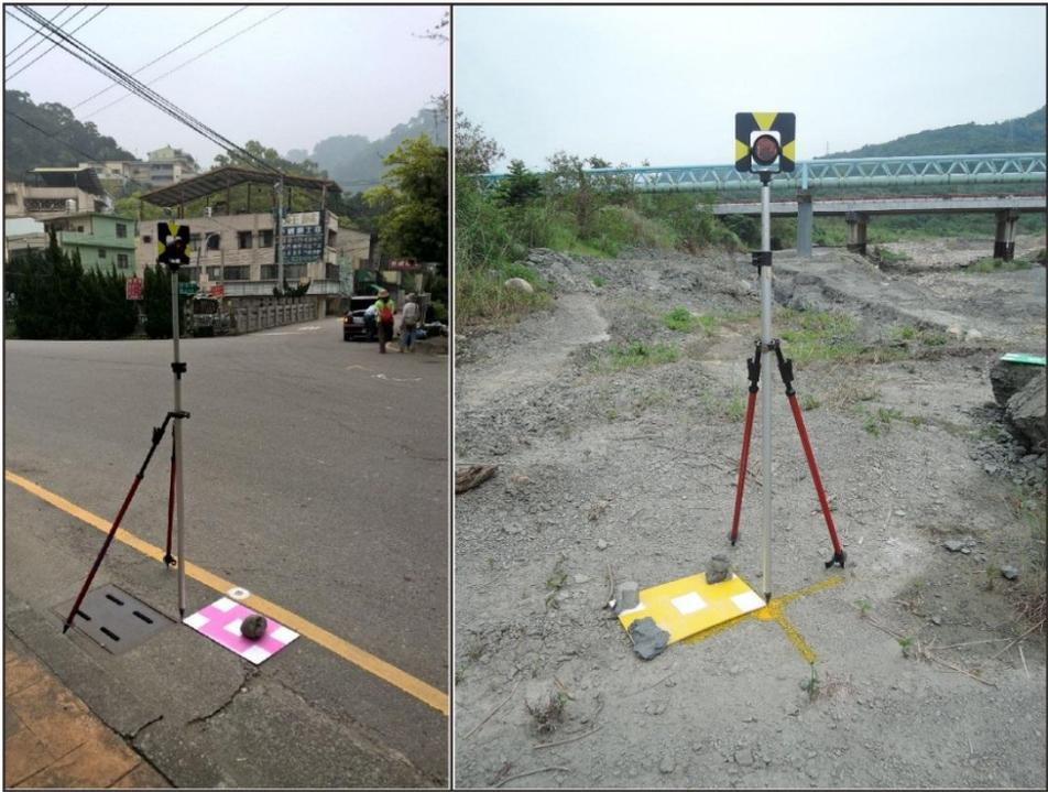
圖 38 野外布置控制點情況。若有人為設施邊界(如水溝蓋邊角)可直接使用，若無可用的邊角，則於地面上噴漆示意。
