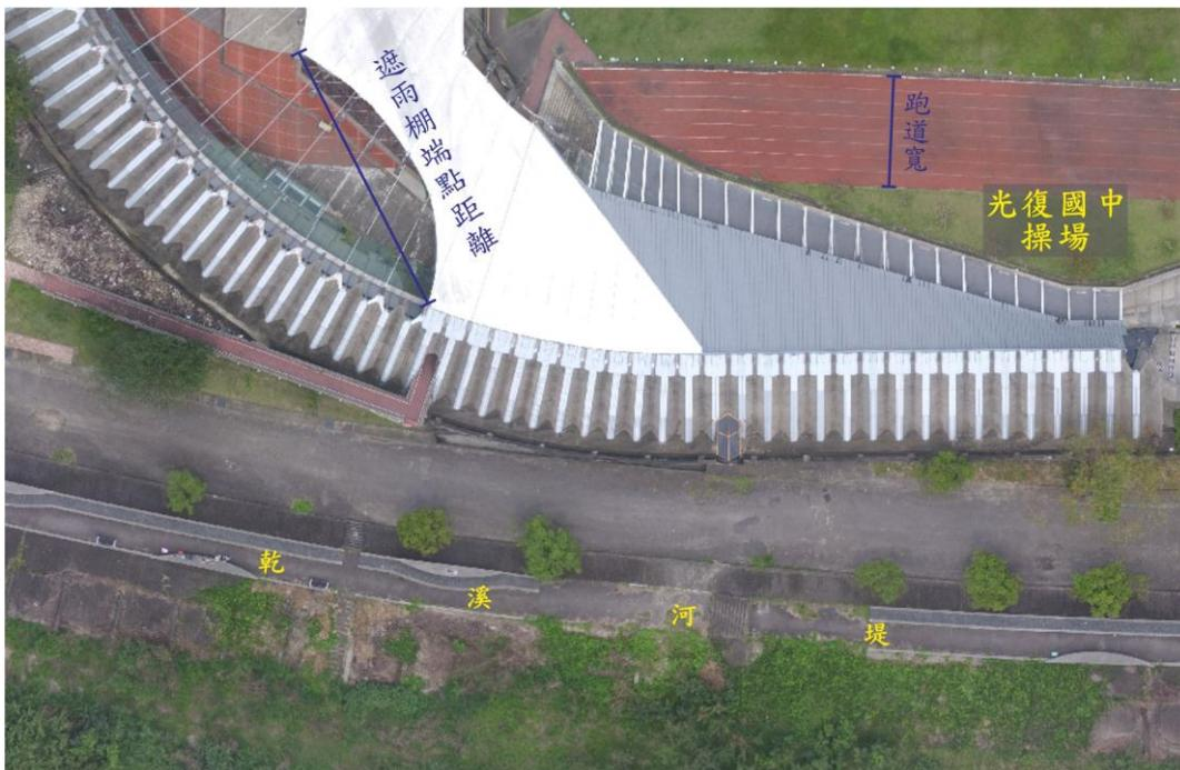
圖 46 標地物測量示意圖。本研究比較製作正射影像與農航所正射影像中遮雨棚端點距離與跑道寬。
