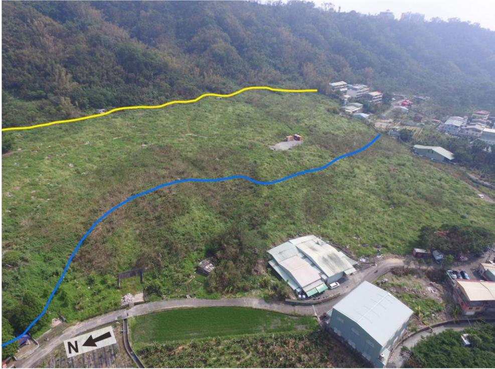
圖 99 豐原第二公墓空照圖(於 2016 年 9 月拍攝)。黃色線為集集地震發生之前已存在的地形線形，藍線為集集地震時產生的地形線形現今位置。
