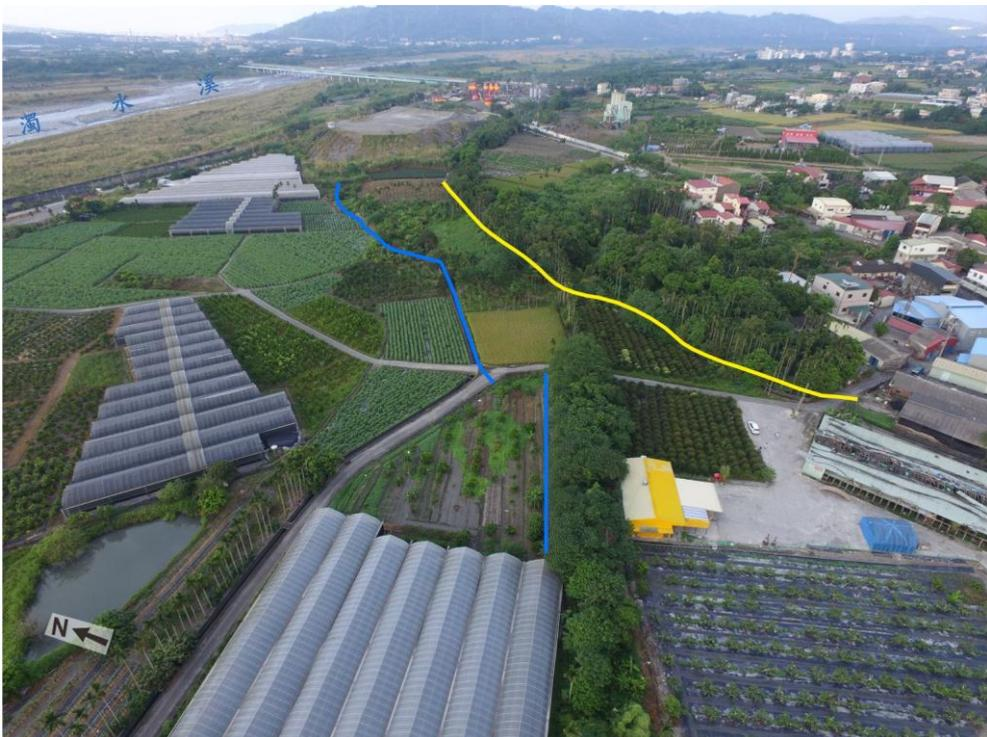
圖 100 水底寮地區空照圖。黃色線為集集地震發生之前已存在的地形線形，藍線為集集地震時產生的地形線形現今位置。
