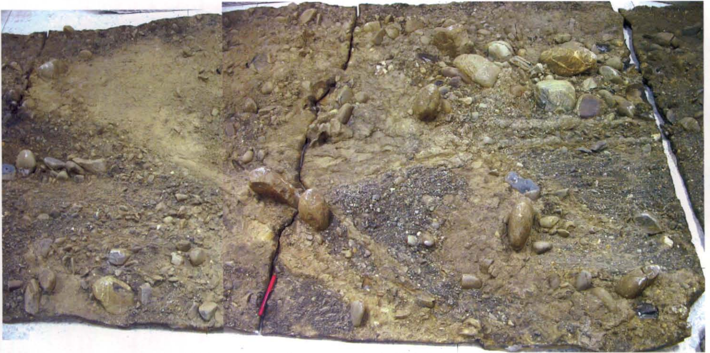
圖十六 瑞穗斷層的槽溝剝製標本。從原本水平礫石層的錯移撓曲及礫石顆粒的排列方式可研判出幾次的古地震事件。此剖面記錄兩次古地震事件，你找出來了嗎？
