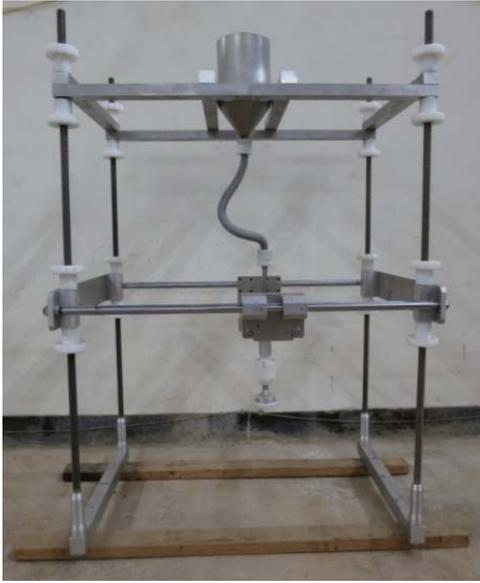
圖五 移動式霽降儀
